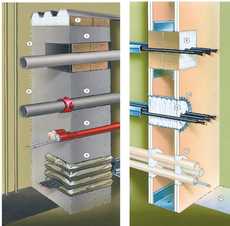
Rys. 2. Zabezpieczone przepusty instalacyjne
